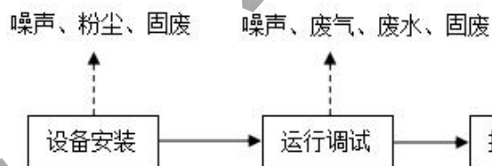
图 2-2 施工作业流程及产污环节图
